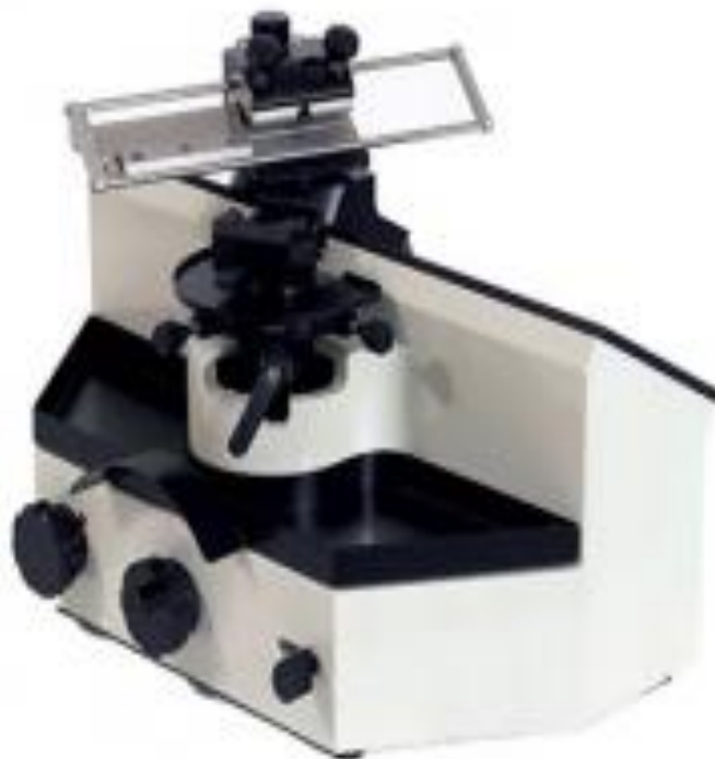
Рис. 13. Микротом РФМ (Германия). Санный микротом: толщина среза (1 – 40 мкм), размер образца (50х60 мм), ориентируемый держатель образца, вращаемый держатель ножа.
